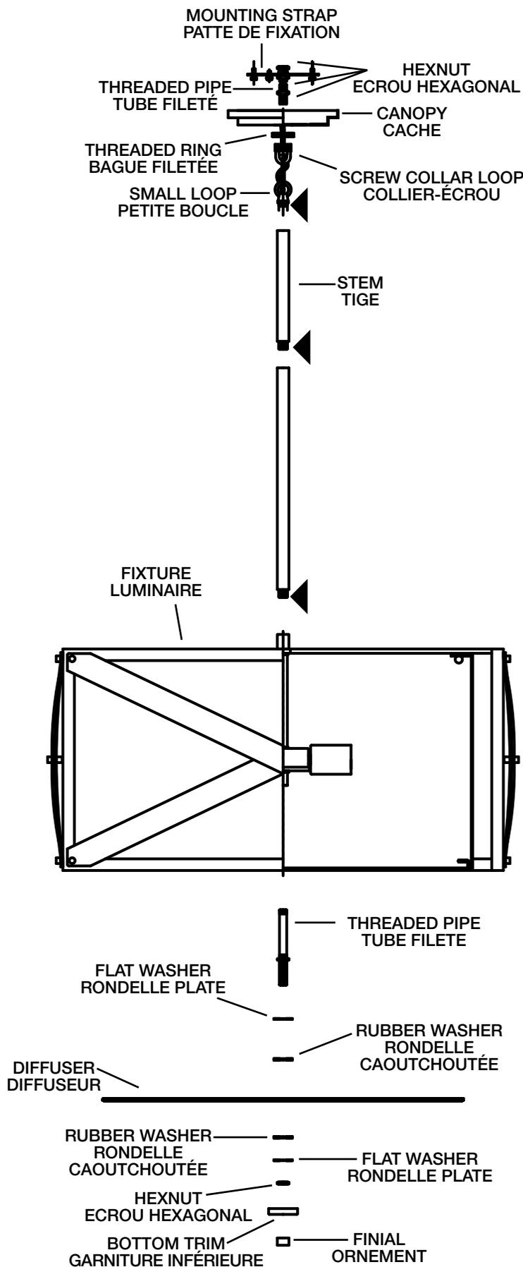
24) Visser l'écrou hexagonal sur le tube fileté. (NE PAS serrer avec excès).
